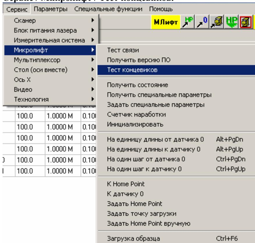
Данная команда позволяет произвести тестирование (считывать реальное состояние в реальном времени) датчика нуля и датчиков предельных перемещений (при наличии таковых).
