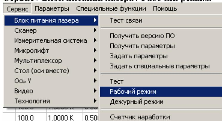
Данная команда введена исключительно для целей тестирования. Она позволяет перевести лазер в рабочий режим (включить ток питания светодиодов). При выполнении данной команды необходимо, чтобы устройство было включено и переведено в режим внешнего управления. При правильной работе связи на экране должно появиться сообщение о том, что команда выполнена.
