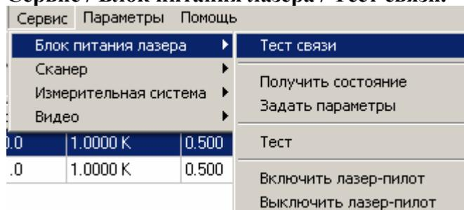
Данная команда позволяет проверить правильность работы связи (по последовательному порту) компьютера и контроллера блока питания лазера.
