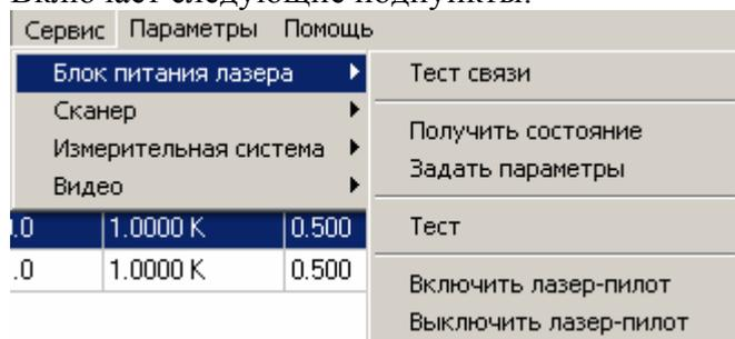
Все пункты данного подпункта обращаются к контроллеру блока питания лазера по линии связи. Если связь нарушена, контроллер блока выключен и т.п., на экран будет выведено примерно такое сообщение об ошибке:
