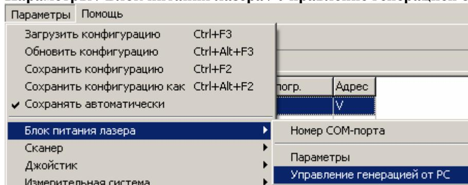
Данная команда позволяет выбрать параметры управления разрешением генерации лазерных импульсов.
