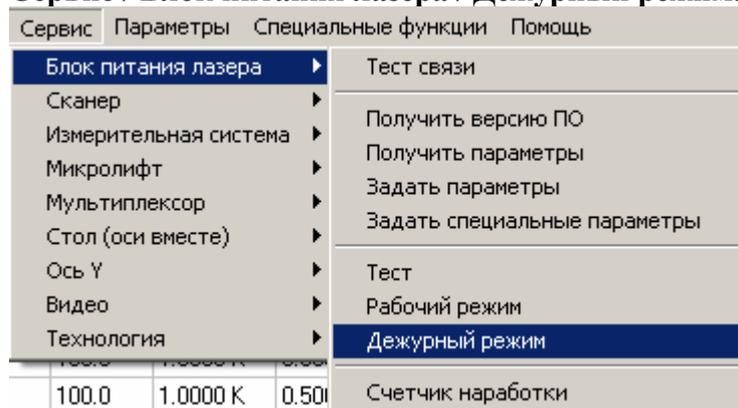
Данная команда введена исключительно для целей тестирования. Она позволяет перевести лазер в дежурный режим (выключить ток питания светодиодов). При выполнении данной команды необходимо, чтобы устройство было включено и переведено в режим внешнего управления. При правильной работе связи на экране должно появиться сообщение о том, что команда выполнена.
