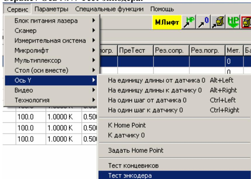
Данная команда введена исключительно для целей тестирования. Выводит на экран текущее состояние счетчика импульсов энкодера для данной оси (при наличии такового, естественно).
