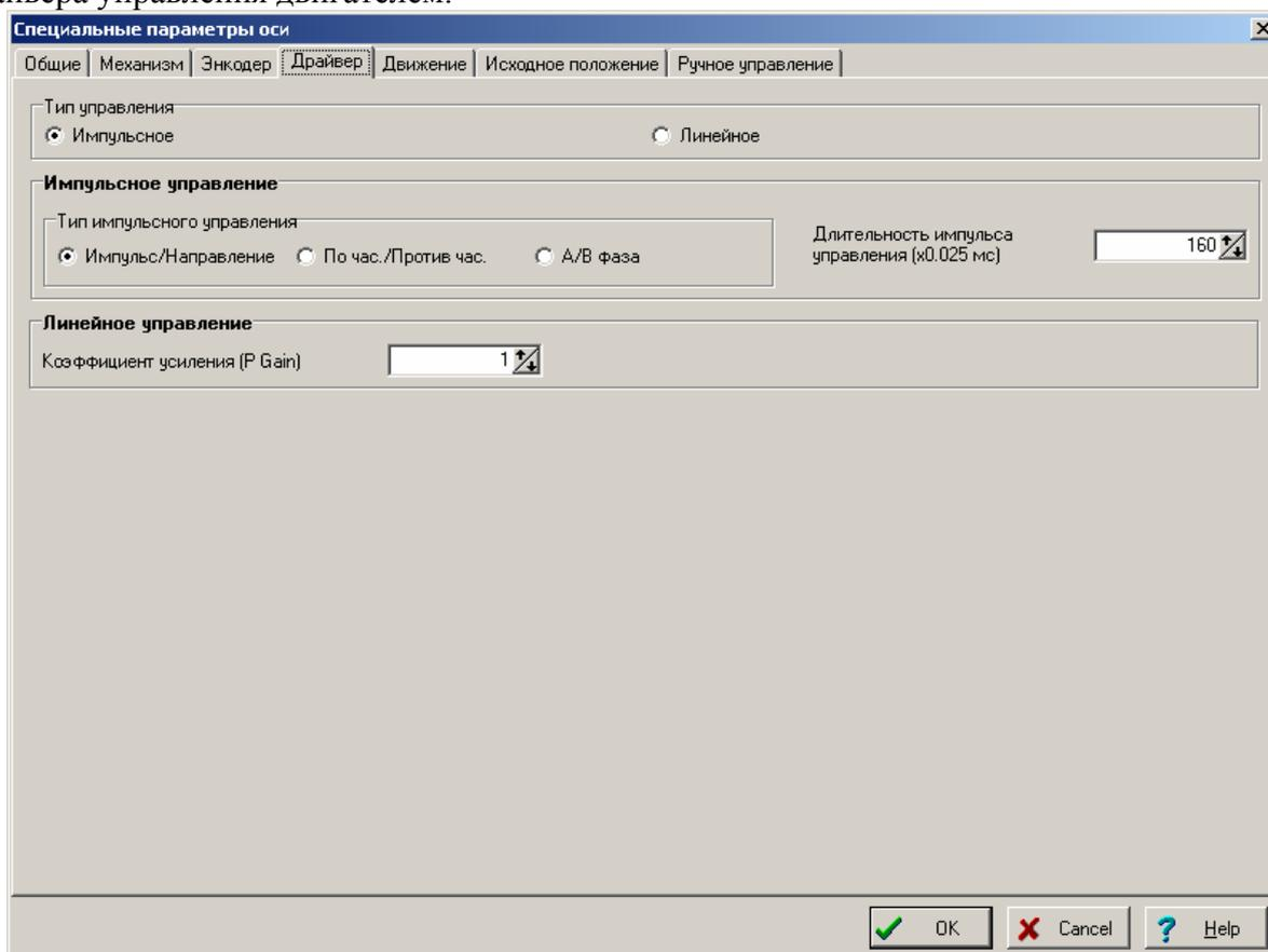
В разделе «Тип управления» необходимо выбрать вариант «Импульсное» при работе с шаговыми двигателями, «Линейное» - при работе с аналоговыми двигателями (двигатели постоянного тока и т.п.).
