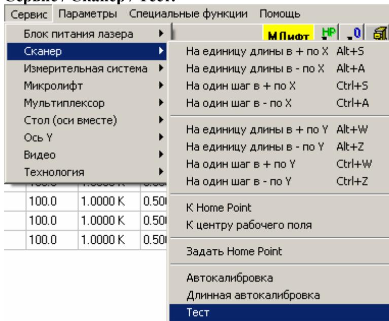
Данная команда позволяет произвести тест сканера – осуществлять его движение по квадрату заданного размера с заданной скоростью, с включенными или выключенным лазером.
