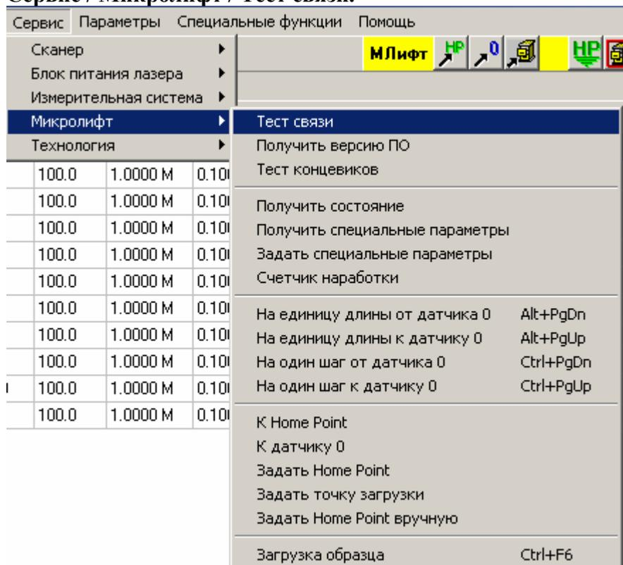
Данная команда позволяет проверить правильность работы связи (по последовательному порту) компьютера и контроллера микролифта.
