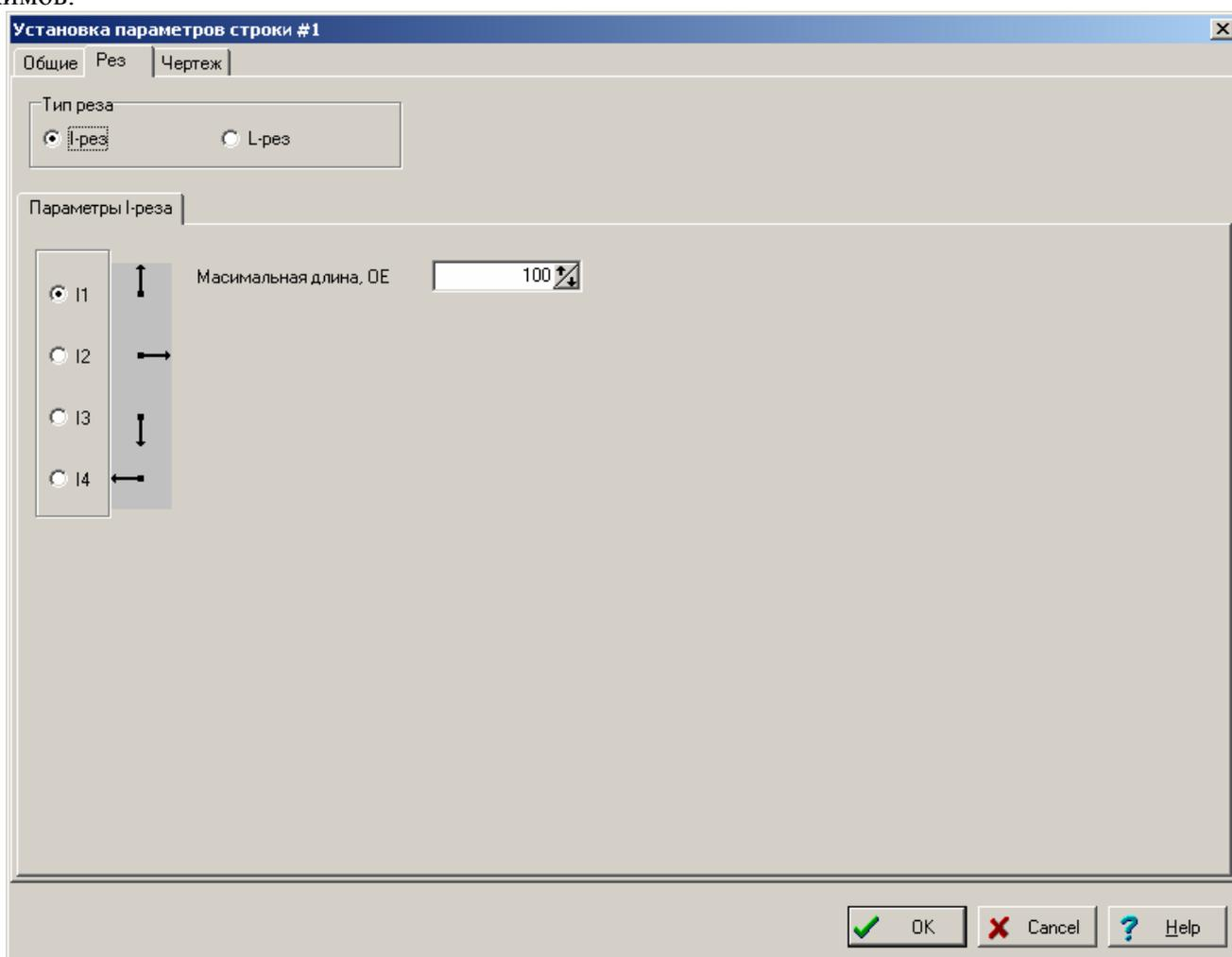
В зависимости от типа реза (пока реализованы 2 – отрезок (I-рез) и два совмещенных отрезка (L-рез) ) вид вкладки может быть разным.
