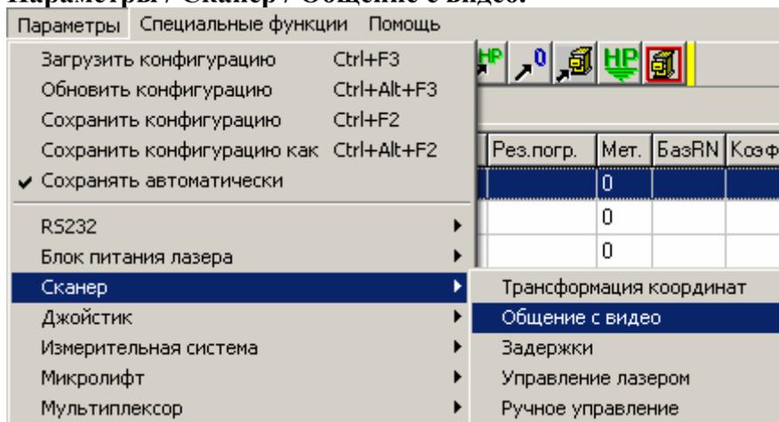
Из-за особенностей оптической системы ход лучей в видимой области и лазерного луча при больших углах отклонения сканерной головки не совпадает. Поэтому перекрестие сетки начинает «отставать» от лазерного луча. Для того, чтобы скомпенсировать этот эффект, программа вывода видеоизображения «умеет» сдвигать сетку, а данная программа сообщать, на сколько сетку нужно подвинуть.
