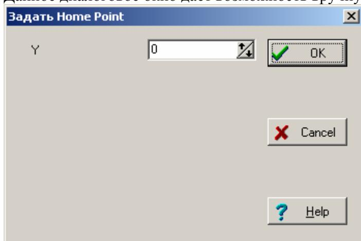
Видимы окна ввода только для тех координат, которые объявлены используемыми и имеющими датчик нуля.
