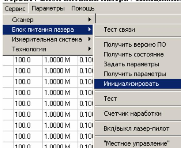
Данная команда заставляет контроллер блока питания проделать действия, переводящие блок в исходное состояние. Подробности о работе блока питания лазера изложены в его описании.
