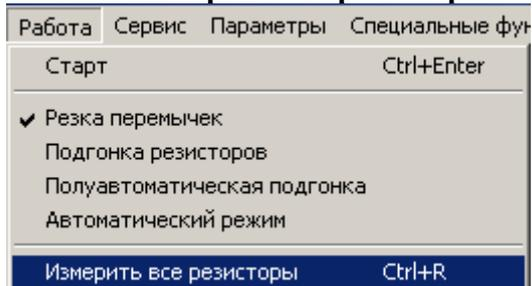
Данный пункт меню действует только для варианта машины с возможностью автоматической подгонки с задействованным мультиплексором. При его выборе производится автоматическое измерение текущих значений сопротивлений в ряду. Результаты заносятся в графы «ПреТест» и «Рез.сопр.» технологической таблицы.
