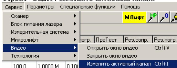
Данная команда позволяет изменить активный канал видео. Будет работать для программы MLVideo с двумя каналами видео с отдельными настройками.
