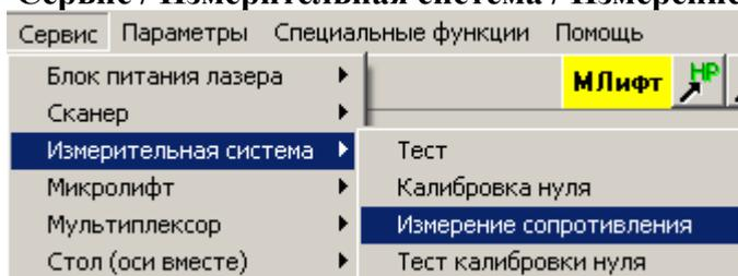
Данная команда позволяет производить измерение подгоняемого резистора без какого-либо управления лазером. Также при исполнении данной команды возможно проведение точного измерения коэффициента преобразования показаний АЦП в величину измеряемого сопротивления для заданного диапазона и его запоминание.
