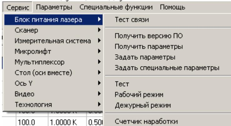
Все пункты данного подпункта обращаются к контроллеру блока питания лазера по линии связи. Если связь нарушена, контроллер блока выключен и т.п., на экран будет выведено примерно такое сообщение об ошибке:
