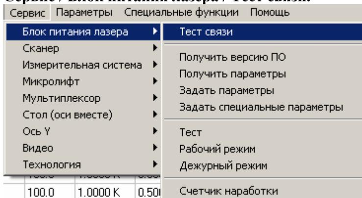
Данная команда позволяет проверить правильность работы связи (по последовательному порту) компьютера и контроллера блока питания лазера.
