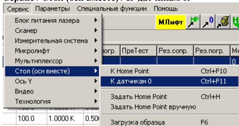
Данная команда позволяет переместить стол в начальную точку отсчета координат, определяемую датчиками нулевого положения стола. Эта команда позволяет, например, восстановить утраченную при аварийном останове или другом сбое в движении привязку координат к реальному положению стола. Выполняется для тех осей, для которых задано, что датчик нулевого положения присутствует. В противном случае текущее положение для данной оси принимается за начальную точку отсчета.
