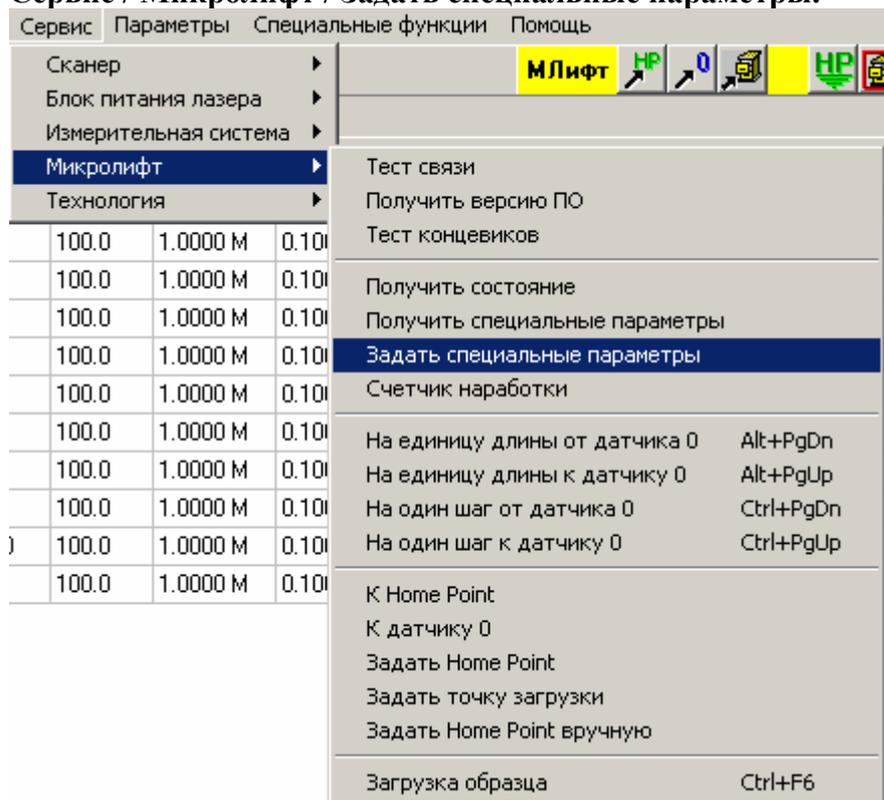
Данная команда позволяет передать специальные параметры устройства, установленные в программе, собственно в устройство.
