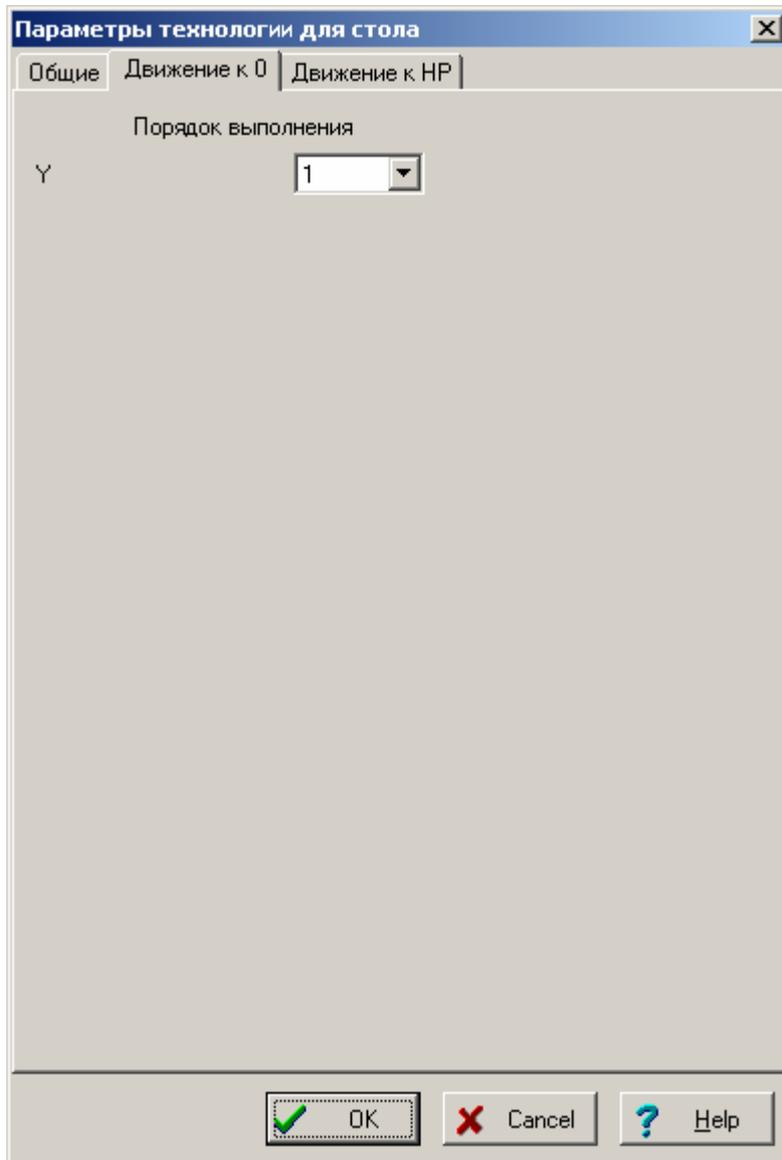
На страничке «Движение к НР» расположены параметры, определяющие порядок перемещения осей при движении к Home Point. Чем меньше будет этот параметр для оси, тем раньше она начнет движение. Оси с большим порядком начнут движение только после окончания движения осей с меньшим порядком.
