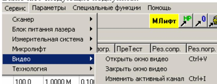
Пункт относится к работе с программой вывода изображения с видеокамеры на экран монитора компьютера. Он называется MLVideo.exe и поставляется в составе программного пакета.
