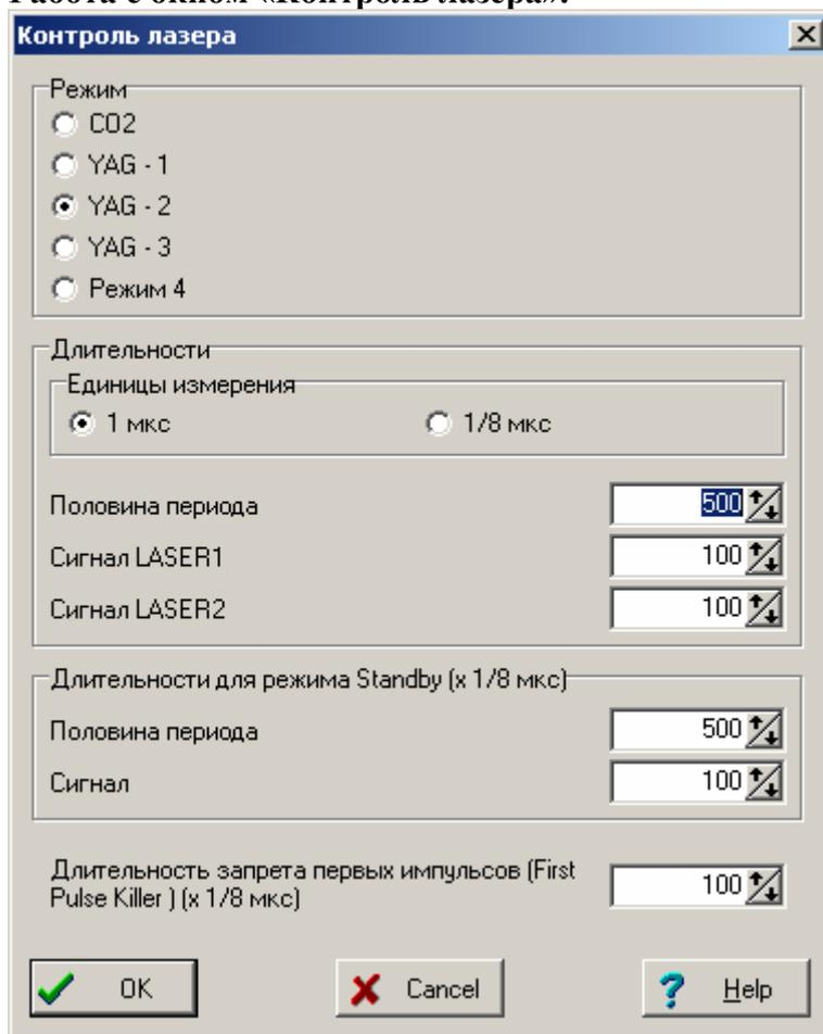
Данная команда позволяет установить параметры сканера, отвечающие за формирование импульсов управления лазером.
