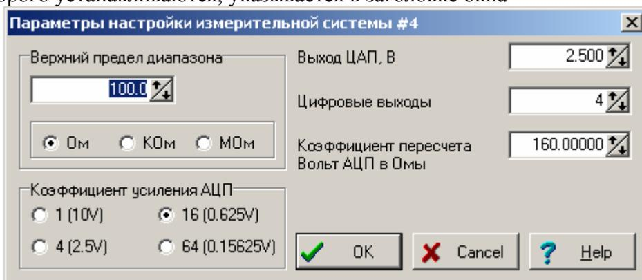
В разделе «Верхний предел диапазона» установите величину и диапазон сопротивления. При подгонке сопротивления с номинальной величиной R автоматически будут установлены параметры измерительной системы для поддиапазона, верхний предел которого наиболее близок, но больше или равен R.
