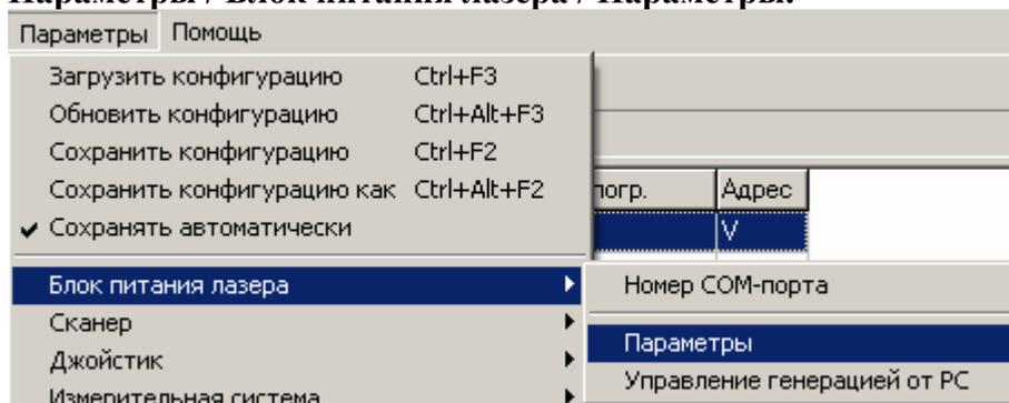
Данная команда позволяет выбрать параметры блока питания лазера, которые будут использоваться в процессе отработки задания. При выполнении данной команды на экране появится диалоговое окно, позволяющее изменить соответствующие параметры устройства. Установите нужные параметры и нажмите кнопку "ОК".
