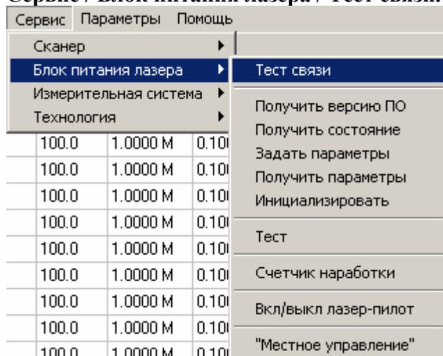
Данная команда позволяет проверить правильность работы связи (по последовательному порту) компьютера и контроллера блока питания лазера.
