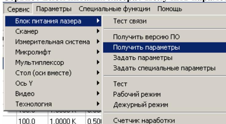
Данная команда позволяет считать ранее установленные (из программы или в ручном режиме) параметры устройства.
