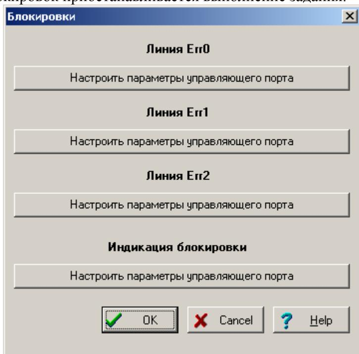
Исходно в программе заложена возможность опроса 3 входных линий, в которые «упакованы» различные варианты блокировок или неисправностей. Также есть 1 линия – индикация состояния блокировочной системы.
