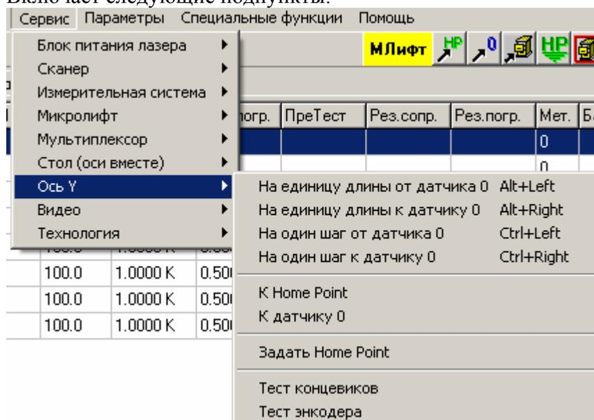
Этот пункт выглядит одинаково для всех задействованных осей стола. Отличаются только горячие клавиши для первых четырех подпунктов – в соответствии с настройками в специальных параметрах соответствующей оси.
