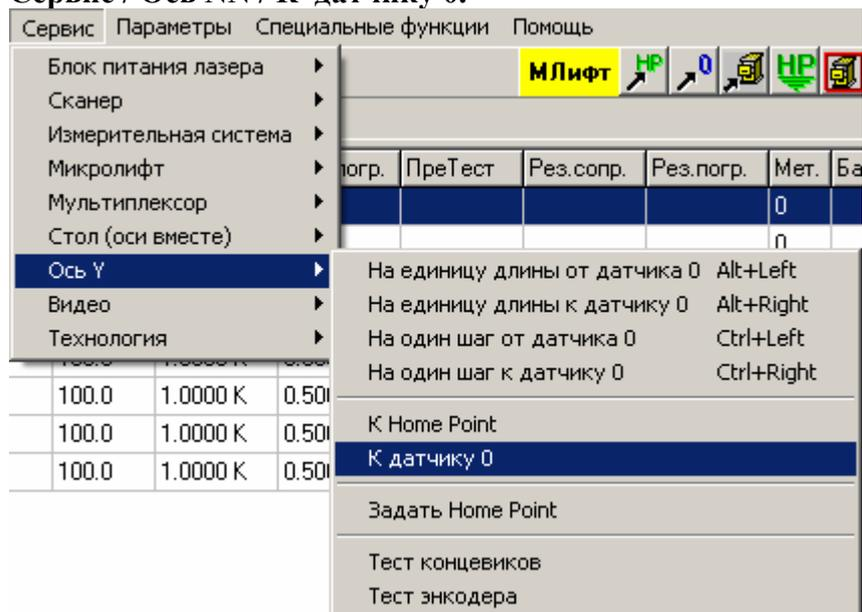
Данная команда позволяет переместить **только данную ось** в начальную точку отсчета координат, определяемую датчиком нулевого положения стола. Введена в основном для целей тестирования.
