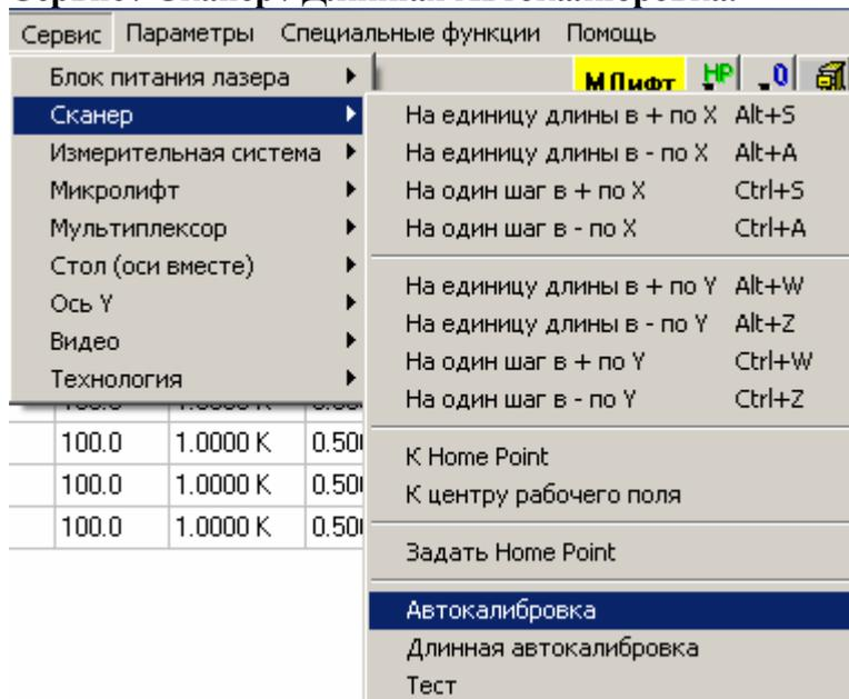
Данная команда позволяет произвести калибровку сканера (для вариантов головок, имеющих такую опцию). Различие между обычной и длинной (полной) калибровками смотри в описании на сканер.
