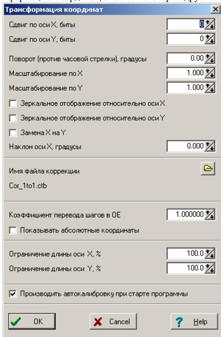
Параметры в первом разделе для данной машины не нужны. Рекомендуем оставить их как есть и не менять. Они здесь видны только потому, что программный модуль управления сканером используется в других программах, где они важны.
