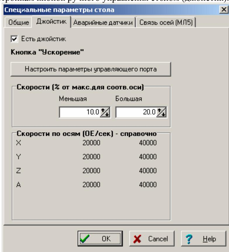
Установите флажок «Есть джойстик», если такое устройство в машине присутствует, и снимите в противном случае.
