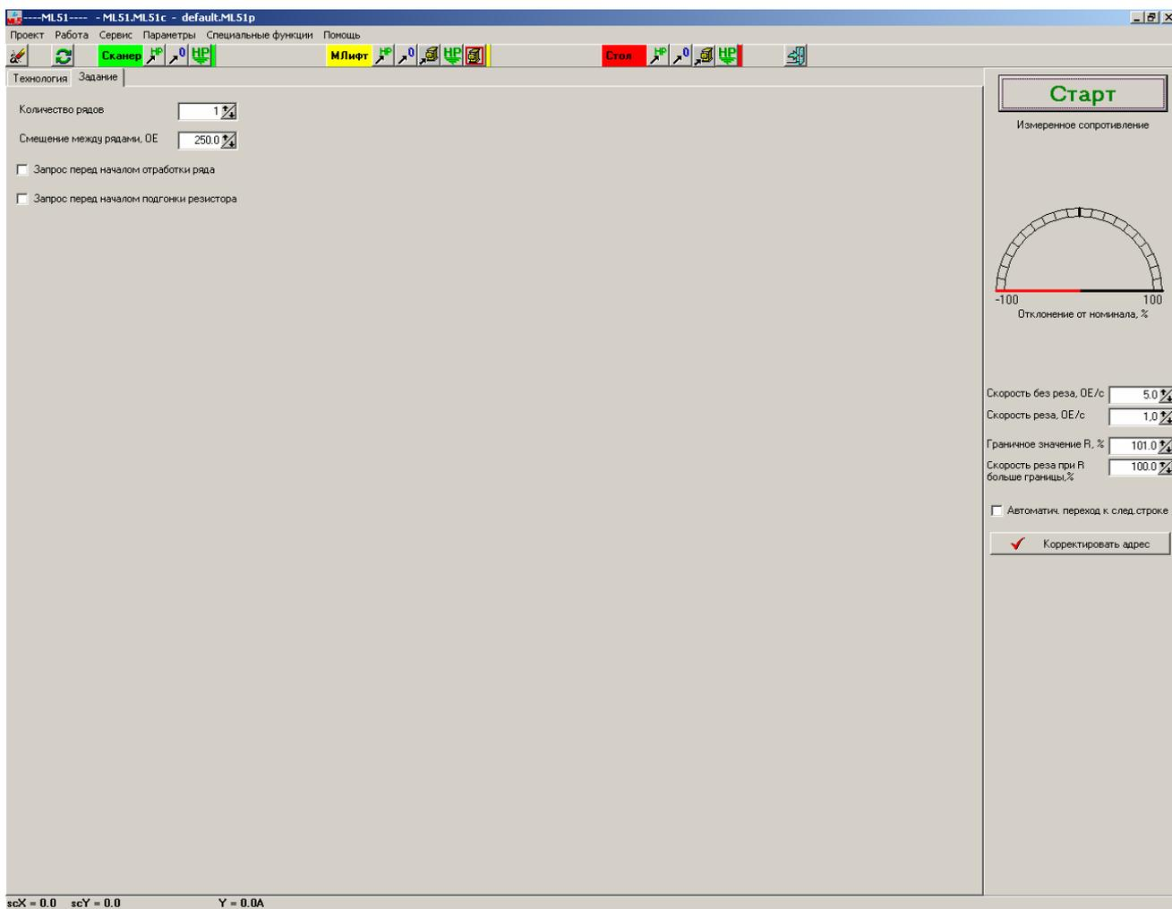
Вкладка «Задание» появляется только для вариантов машин с возможностью автоматической подгонки – имеющих микролифт и координатный стол. Для разных подобных вариантов будет виден различный набор установок. Для варианта технологии со щупом с рядом иглолок (с мультиплексором) эти параметры – количество повторов, рядов и т.п., а также необходимость остановить выполнение задания и запросить подтверждение продолжения. Значение задаваемых на данной вкладке параметров очевидно.
