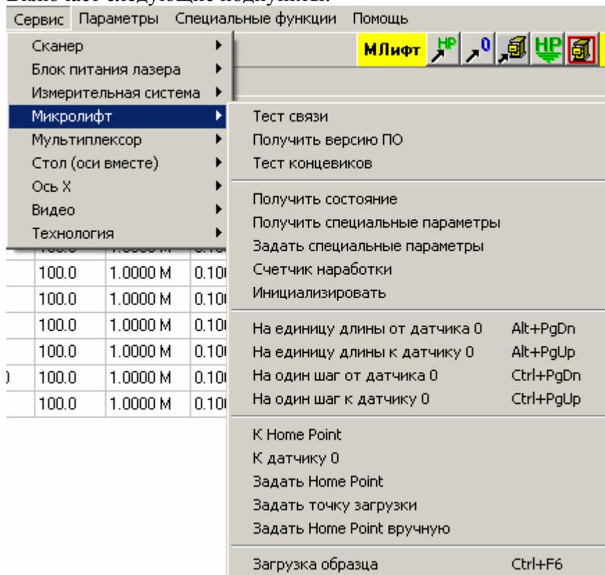
Все пункты данного подпункта обращаются к контроллеру микролифта по линии связи. Если связь нарушена, контроллер микролифта выключен и т.п., на экран будет выведено примерно такое сообщение об ошибке:
