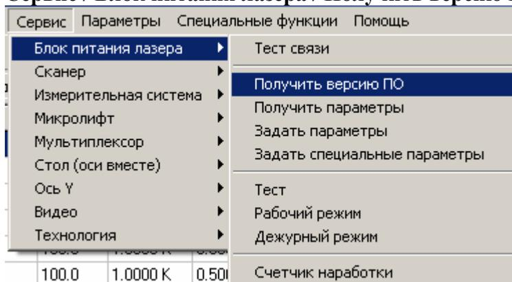
Данная команда позволяет получить от контроллера информацию о версии программного обеспечения. При правильной работе связи на экране должно появиться сообщение о версии ПО устройства. Примерно такое:
