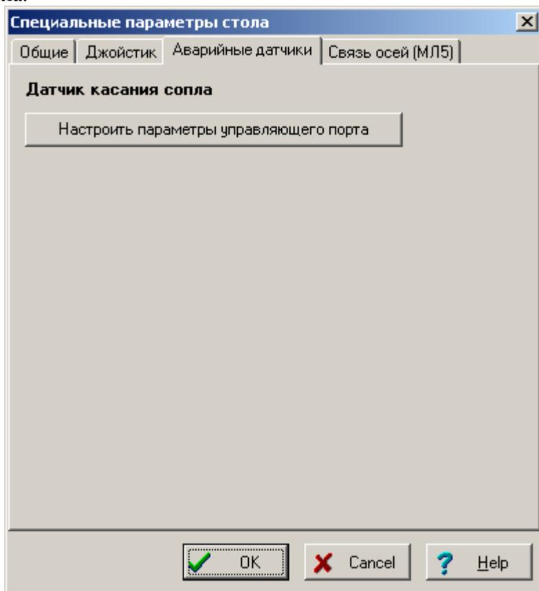
Для установки параметров датчика касания сопла нажмите кнопку «Настроить параметры управляющего порта», расположенную под заголовком «Датчик касания сопла». Естественно, данная настройка имеет смысл только при наличии соответствующего датчика, да и самого сопла. В появившемся стандартном диалоговом окне настройки управляющего порта настройте соответствующие параметры.
