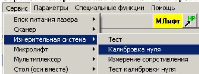
Данная команда предназначена для проведения калибровки нуля измерительной системы. Калибровка нуля проводится для диапазонов сопротивлений ниже 120 Ом и заключается в учете сопротивления щупов и подходящих к ним проводов.
