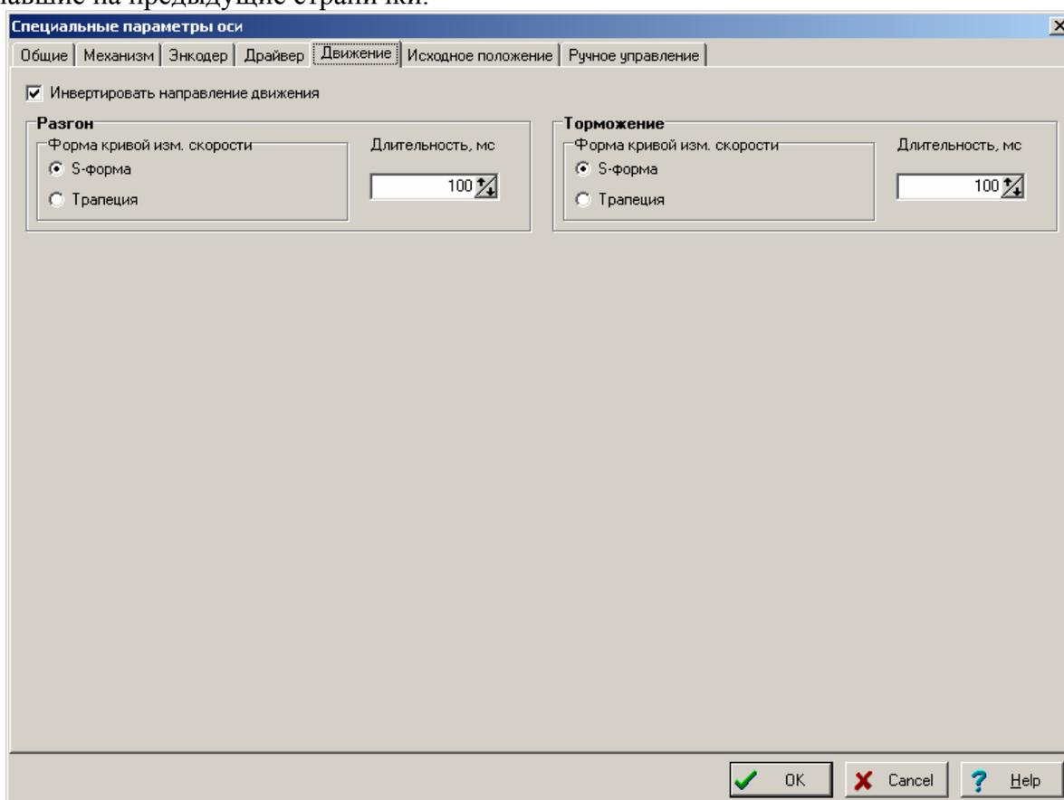
Флажок «Инвертировать направление движения» позволяет сообщить плате управления, что сигналы управления шагами должны быть логически инвертированы. Изменять значение этого флажка следует в том случае, если вместо ожидаемого перемещения по данной оси реальное движение идет в противоположном направлении.
