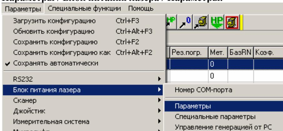
Данная команда позволяет выбрать параметры блока питания лазера, которые будут использоваться в процессе обработки задания. При выполнении данной команды на экране появится диалоговое окно, позволяющее изменить соответствующие параметры устройства. Установите нужные параметры и нажмите кнопку "ОК".
