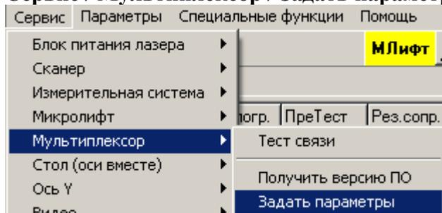
Данная команда позволяет передать параметры устройства, установленные в программе, собственно в устройство.
