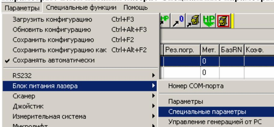
Данная команда позволяет выбрать специальные параметры блока питания лазера, которые будут использоваться в процессе его работы (сохраняются в конфигурации). При выполнении данной команды на экране появится диалоговое окно, позволяющее изменить соответствующие параметры устройства. Установите нужные параметры и нажмите кнопку "ОК".
