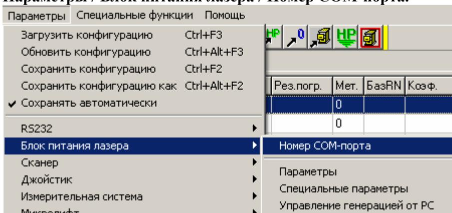
Данная команда позволяет выбрать последовательный порт компьютера, к которому подключается блок питания лазера. При выполнении данной команды на экране появится диалоговое окно с выпадающим списком свободных последовательных портов. Выберите в списке нужный порт и нажмите кнопку "OK".
