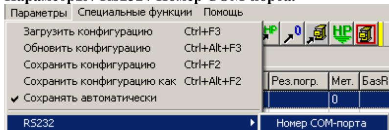
Данная команда позволяет выбрать последовательный порт компьютера, к которому подключаются блоки машины. При выполнении данной команды на экране появится диалоговое окно с выпадающим списком свободных последовательных портов. Выберите в списке нужный порт и нажмите кнопку "OK".
