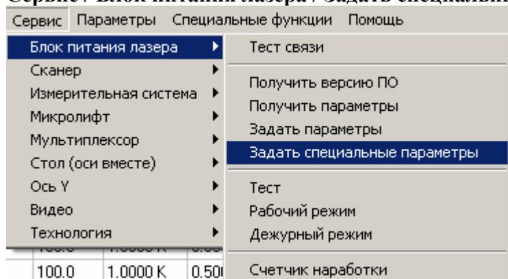
Данная команда позволяет передать специальные параметры устройства, установленные в программе, собственно в устройство.
