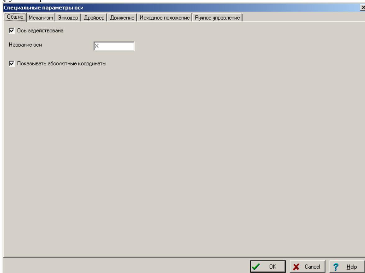
Флажок «Ось задействована» определяет, будет ли данная ось использоваться в данной конфигурации работы машины.
