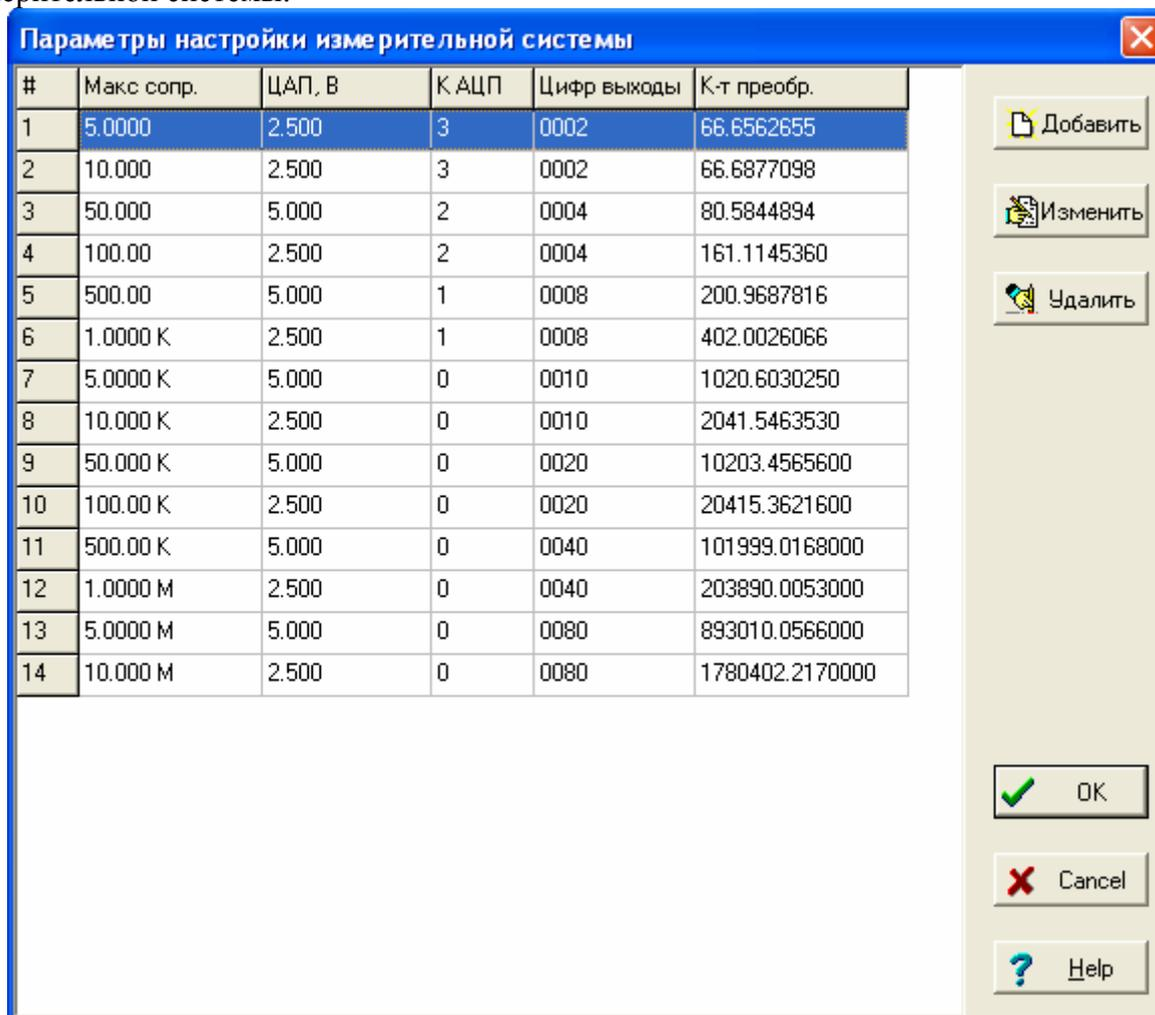
Весь диапазон подгоняемых сопротивлений разбит на поддиапазоны так, чтобы обеспечить максимально возможную точность измерений и подгонки. Указанные поддиапазоны и соответствующие параметры для них и задаются в этом диалоговом окне.
