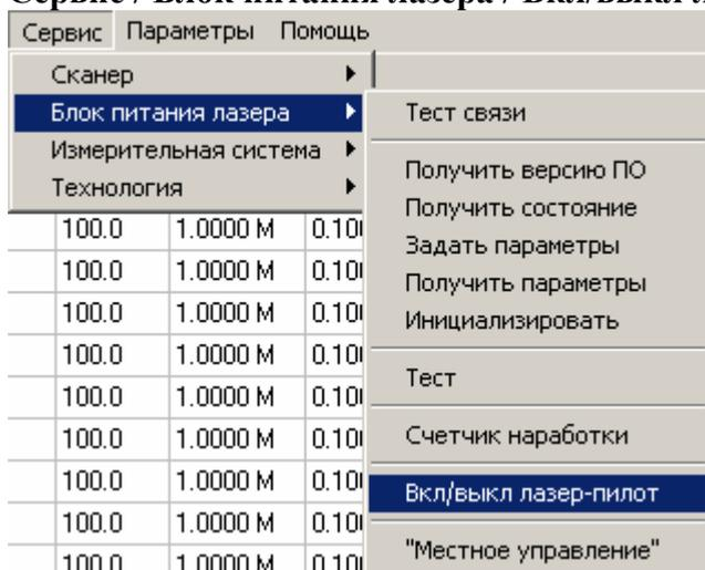
Данная команда позволяет изменить текущее состояние лазер-пилота, встроенного в лазер (используется для юстировки оптического тракта).
