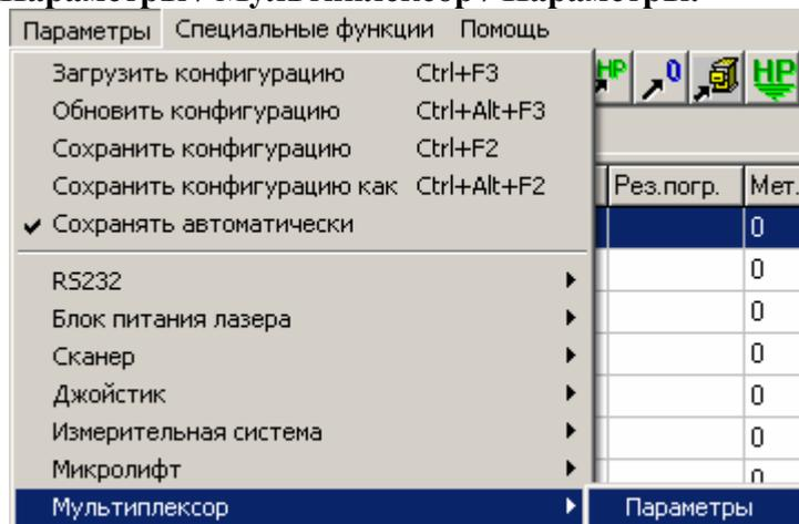
Данный пункт меню позволяет настроить параметры мультиплексора. Впрочем, единственным таким параметром является номер активного щупа. Для того, чтобы выбранный щуп сделать активным, нужно обязательно переслать его значение в мультиплексор командой «Сервис / Мультиплексор / Задать параметры».
