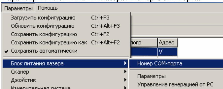
Данная команда позволяет выбрать последовательный порт компьютера, к которому подключается блок питания лазера. При выполнении данной команды на экране появится диалоговое окно с выпадающим списком свободных последовательных портов. Выберите в списке нужный порт и нажмите кнопку "OK".
