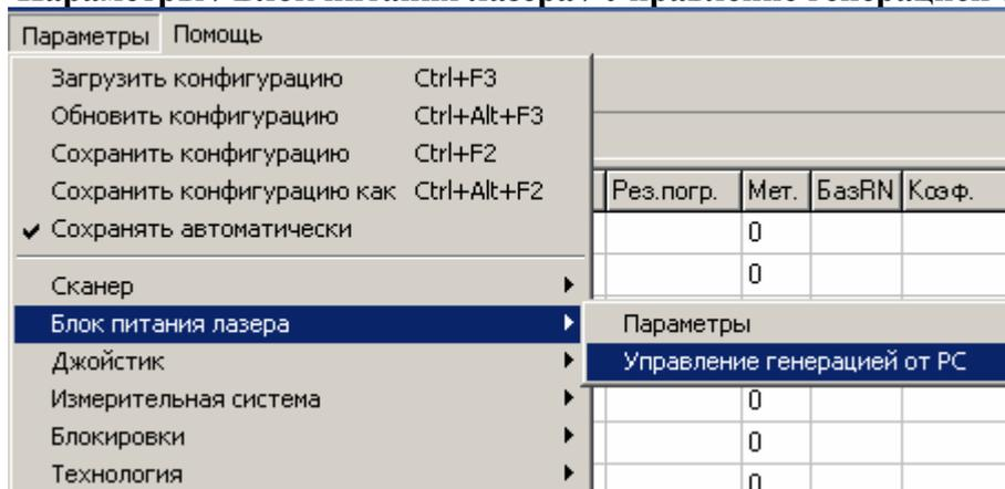
Данная команда позволяет выбрать номер порта и бит в нем, с помощью которого будет производиться управление разрешением генерации лазерных импульсов.
