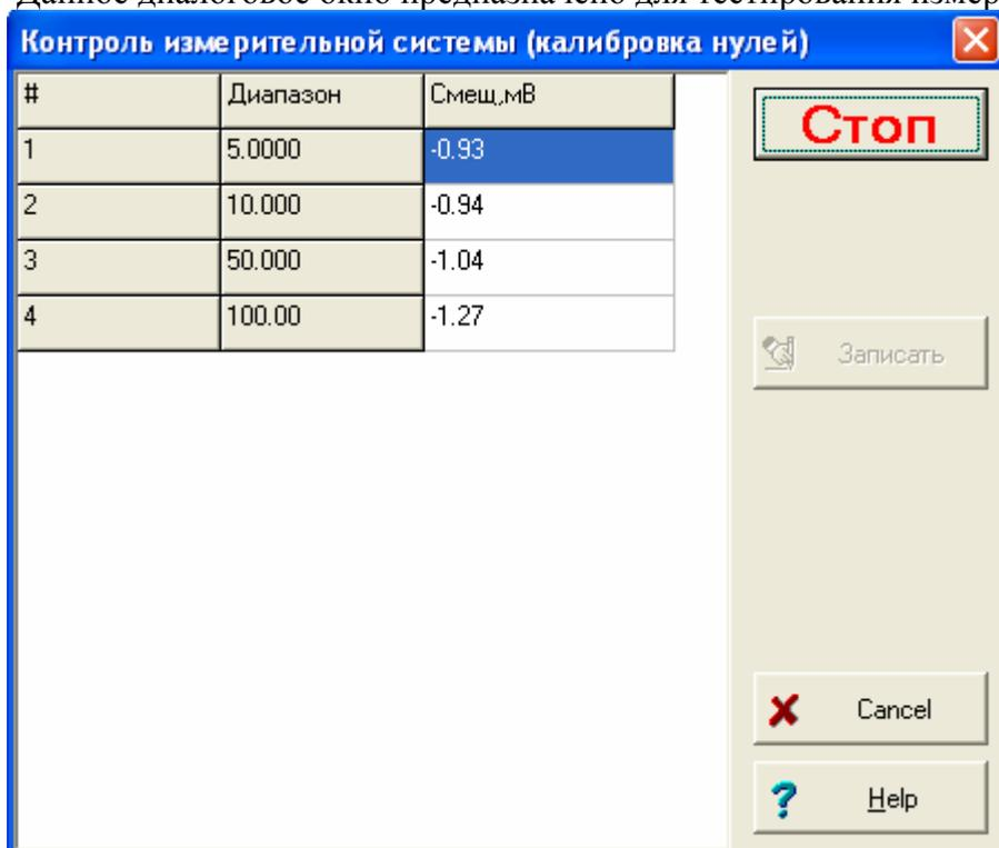
После нажатия кнопки «Старт» программа начнет 1 раз в 3 секунды производить калибровку нулей и выводить измеренные величины в таблицу.
