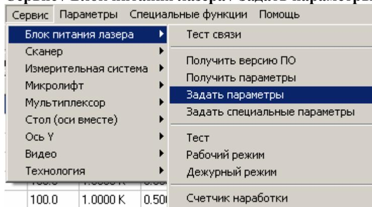
Данная команда позволяет передать параметры устройства, установленные в программе, собственно в устройство.
