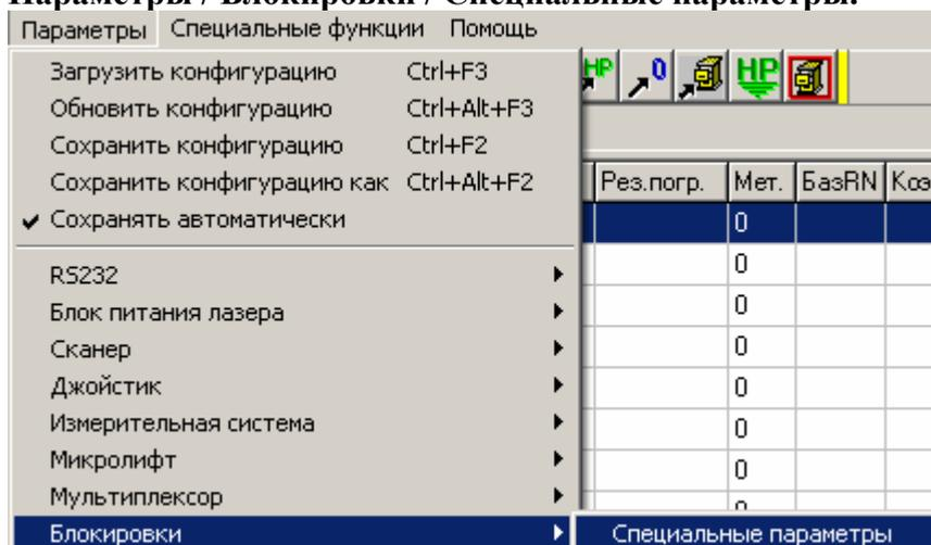
Данный пункт меню позволяет настроить специальные параметры машины в целом, отвечающие за блокировки (сигналы об аварии, неисправности и т.д.). При срабатывании блокировок приостанавливается выполнение задания.
