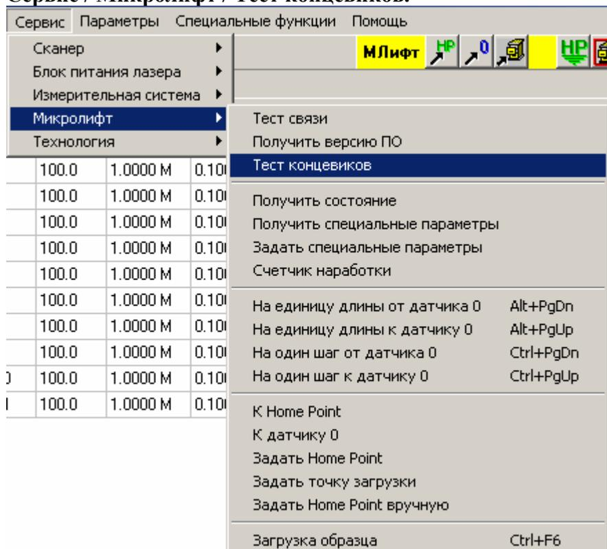
Данная команда позволяет произвести тестирование (считывать реальное состояние в реальном времени) датчика нуля и датчиков предельных перемещений (при наличии таковых).
