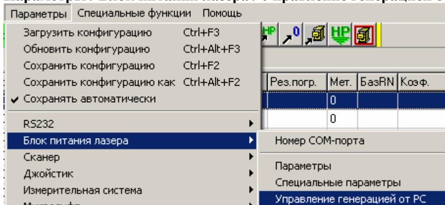
Данная команда позволяет выбрать параметры управления разрешением генерации лазерных импульсов.
