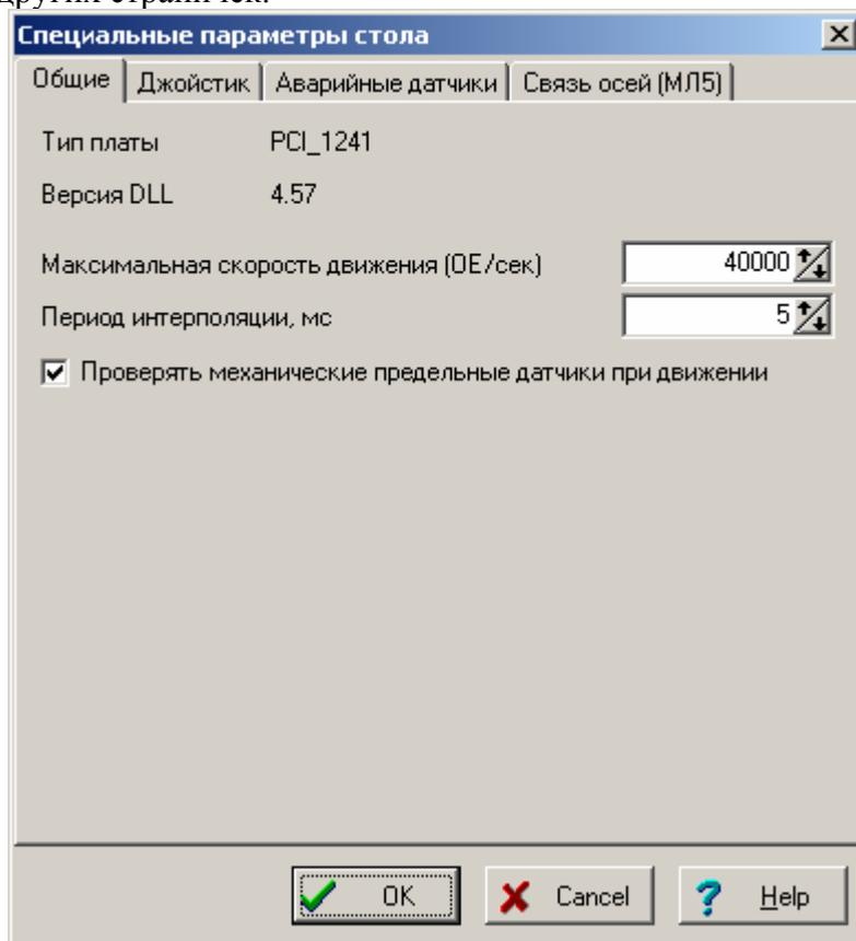
В строках «Тип платы» и «Версия DLL» выводится справочно информация об использованной плате управления координатным столом и текущая версия ее программного обеспечения.
