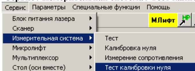
Данная команда позволяет производить тест калибровки 0 – измерение нулей на разных диапазонах, запись всех измеренных значений в файл для возможного дальнейшего анализа их поведения и стабильности.
