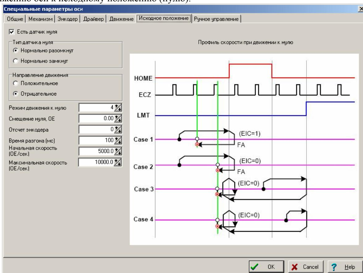
Установите флажок «Датчик нуля», если такой датчик у оси есть. Обычно флажок снимается при использовании оси как вращательной.
