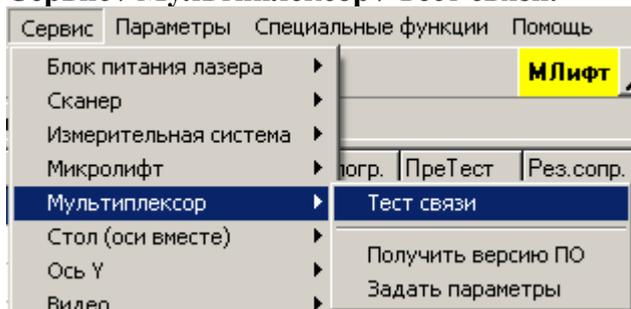
Данная команда позволяет проверить правильность работы связи (по последовательному порту) компьютера и контроллера мультиплексора.
