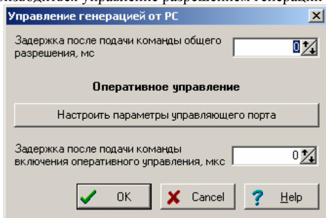
Такой бит, называемый «Оперативное управление», включается перед началом каждого вектора с работой лазера и выключается после его окончания.
