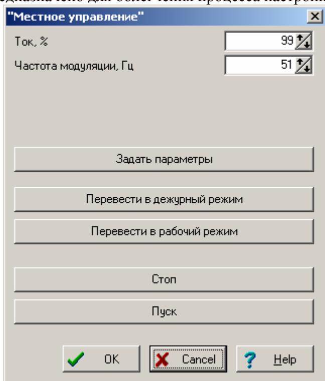
Окно аналогично окну установки параметров блока, только для удобства снабжено кнопками передачи команд, дублирующими часть команд меню Сервис. Команды, отправляемые блоку по линии связи при нажатии соответствующих кнопок, очевидны.
