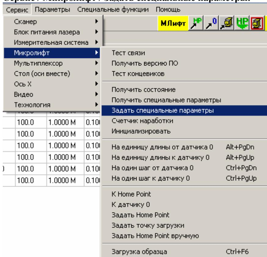
Данная команда позволяет передать специальные параметры устройства, установленные в программе, собственно в устройство.
