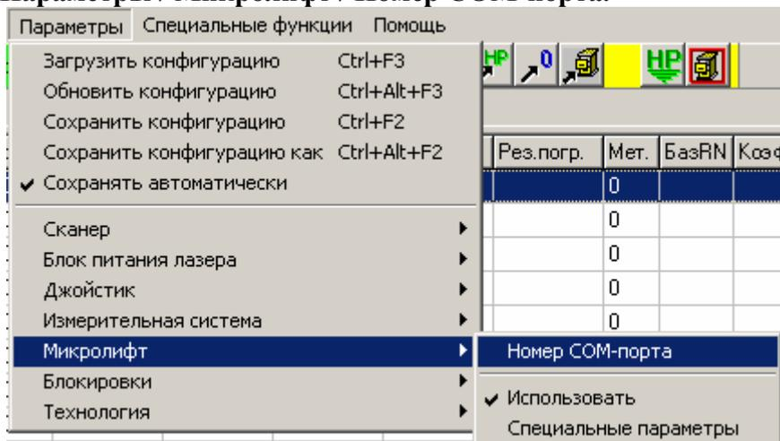
Данная команда позволяет выбрать последовательный порт компьютера, к которому подключается микролифт. При выполнении данной команды на экране появится диалоговое окно с выпадающим списком свободных последовательных портов. Выберите в списке нужный порт и нажмите кнопку "ОК".
