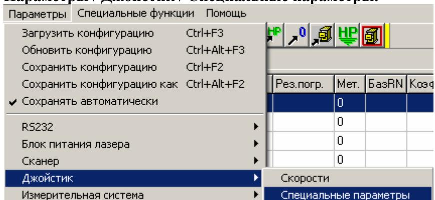
Данная команда позволяет установить специальные параметры джойстика управления движением лазерного луча.
