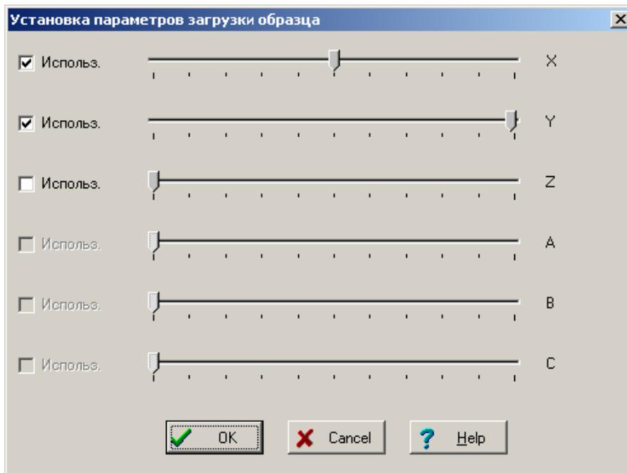
Параметры загрузки могут быть установлены только для осей, параметр «Использовать» для которых включен, и имеющих датчик 0.
