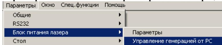
Данная команда позволяет выбрать номер порта и бит в нем, с помощью которого будет производиться управление разрешением генерации лазерных импульсов.
