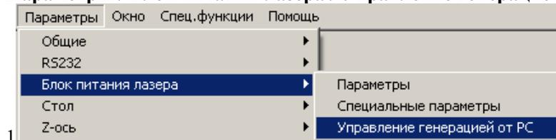
Данная команда позволяет выбрать номер порта и бит в нем, с помощью которого будет производиться управление разрешением генерации лазерных импульсов.
