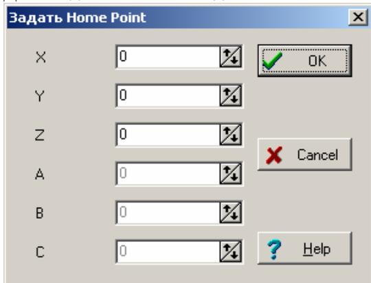
Доступны окна ввода только для тех координат, которые объявлены используемыми и имеющими датчик нуля.
