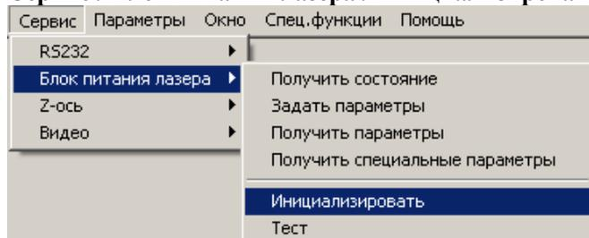
Данная команда заставляет контроллер блока питания проделать действия, переводящие блок в исходное состояние. Подробности о работе блока питания лазера изложены в его описании.
