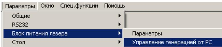
Данная команда позволяет выбрать номер порта и бит в нем, с помощью которого будет производиться управление разрешением генерации лазерных импульсов.
