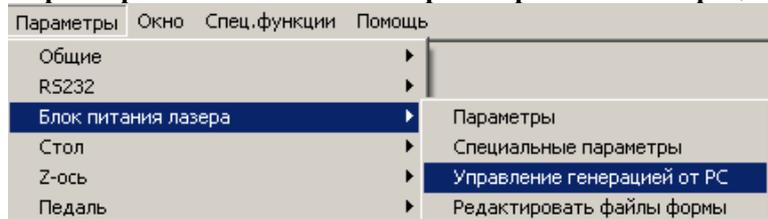
Данная команда позволяет выбрать номер порта и бит в нем, с помощью которого будет производиться управление разрешением генерации лазерных импульсов.
