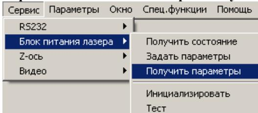
Данная команда позволяет считать ранее установленные (из программы или в ручном режиме) параметры устройства.
