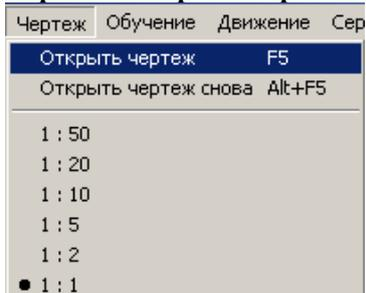
Данная команда позволяет загрузить с диска нужный файл с чертежом. При выполнении данной команды на экране появится стандартное окно для работы с файловой системой.
