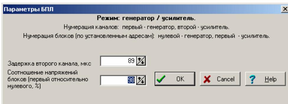
В данном режиме импульсы каналов делаются практически одновременно. Импульс второго канала может быть немного задержан относительно начала первого, но заканчиваются они всегда одновременно.
