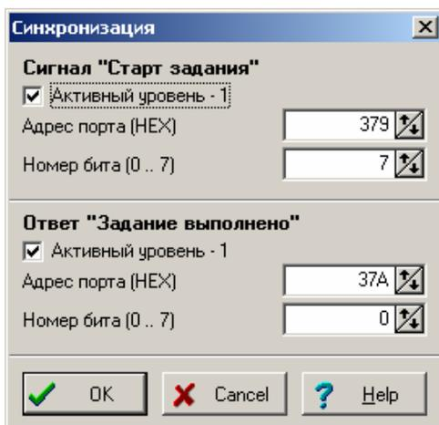
Эти параметры введены для того, чтобы можно было использовать программу без изменений при изменении схемы подключения или других параметров конфигурации системы. Данные параметры задаются производителем и их величины указываются в приложении к паспорту на машину.
