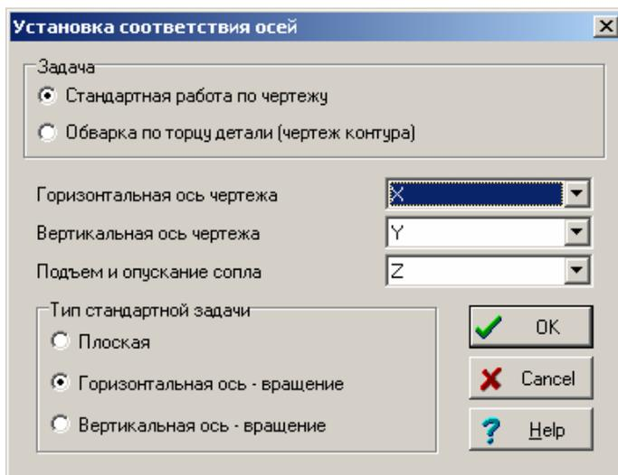
В окнах ввода «Горизонтальная ось чертежа», «Вертикальная ось чертежа» и «Подъем и опускание сопла» выберите названия осей из списка задействованных. Если количество задействованных осей меньше 3, не все указанные окна ввода будут доступны.
