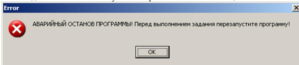
Предложение перезапустить программу объясняется тем, что программа не определила верного положения стола и может в дальнейшем повредить его механизм.
