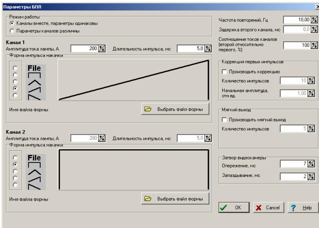
В данном режиме импульсы каналов (разрядных блоков) делаются практически одновременно. Импульс второго канала может быть немного задержан относительно начала первого, но заканчиваются они всегда одновременно.
