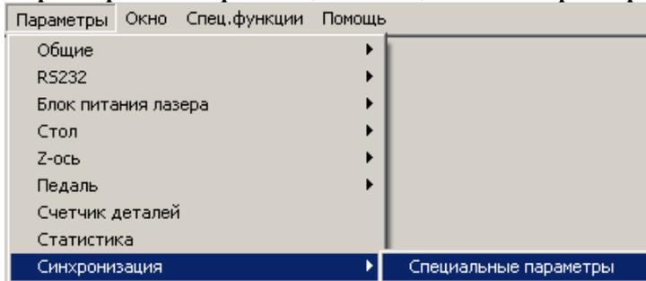
Данная команда позволяет установить параметры синхронизации – настроить, к каким ножкам порта подключаются вход и выход синхронизации старта задания в циклическом режиме. Установите нужные параметры и нажмите кнопку "ОК".
