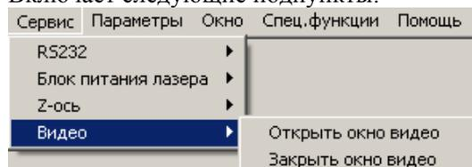
Данный пункт меню позволяет вызывать или закрывать программу вывода видеоизображения на экран монитора. Указанная программа работает при наличии в компьютере специальной платы видеозахвата и подключения выходного сигнала видеокамера СОКа к ней. В последних версиях лазерных машин камера подключается к специальному монитору, и данный пункт меню остался лишь для совместимости со старыми версиями машин.
