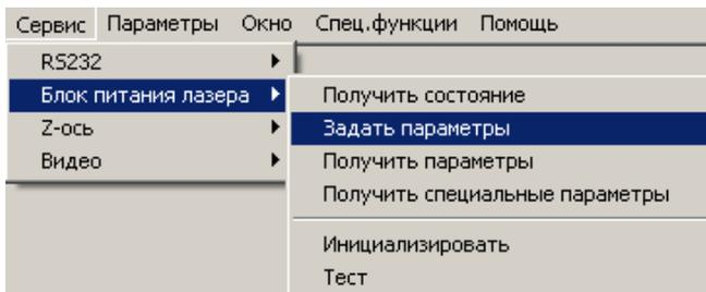
Данная команда позволяет передать параметры устройства, установленные в программе, собственно в устройство.
