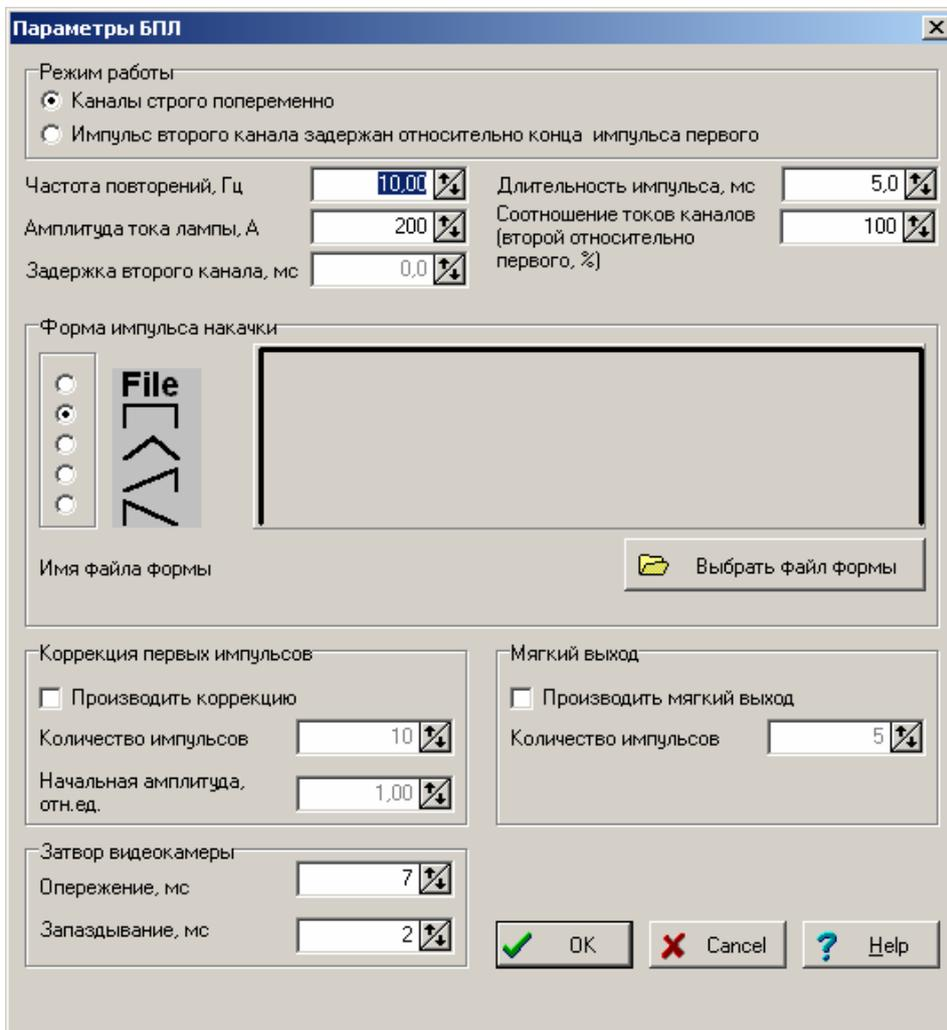
В данном режиме импульсы каналов (разрядных блоков) делаются принципиально в разное время. Импульс второго канала может быть задержан относительно конца первого, либо каналы могут работать строго попеременно.
